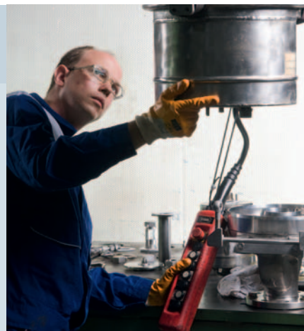
WARTUNG eines Flammenschutzventils
